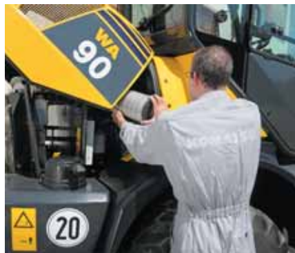
Accès pratique au filtre à air
