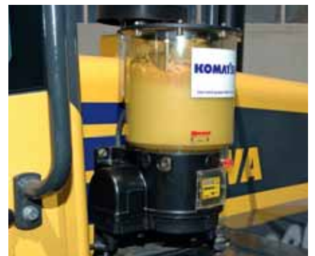
Lubrification centrale automatique
