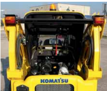
Capot: contrôle rapide des éléments du moteur
