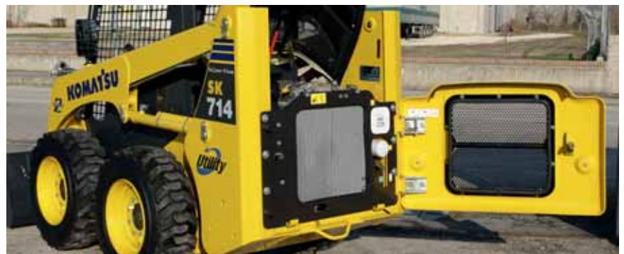
Hayon arrière: inspection et nettoyage aisés des radiateurs
