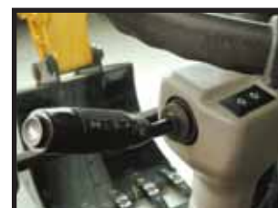
Volant inclinable avec plusieurs fonctions; commande essuie-glace, indicateur, klaxon, phare avant
