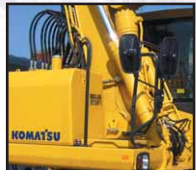
Grande main courante pour accès aisé
