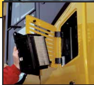
Filtre à air extérieur
