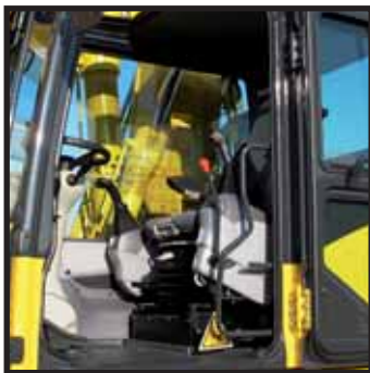
Plage de glissement du siège: 340 mm
