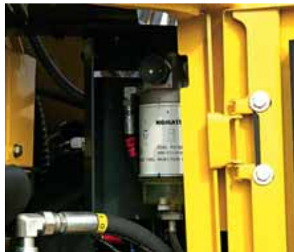
Le préfiltre à carburant avec séparateur d'eau
