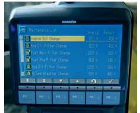
L'écran LCD indique les anomalies et les moments de remplacement.
