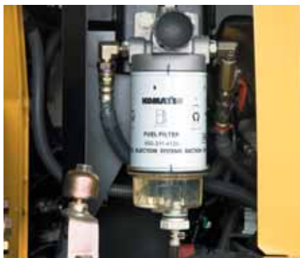
Le préfiltre à carburant avec séparateur d'eau
