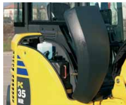
Capot avant: accès aisé au réservoir de carburant
