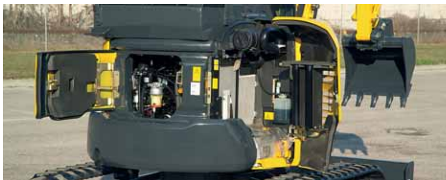
Capots arrières pour contrôle rapide des éléments du moteur, simple inspection et nettoyage des radiateurs et accès facilité à la batterie
