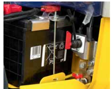
Coupe circuit de l'installation électrique en standard
